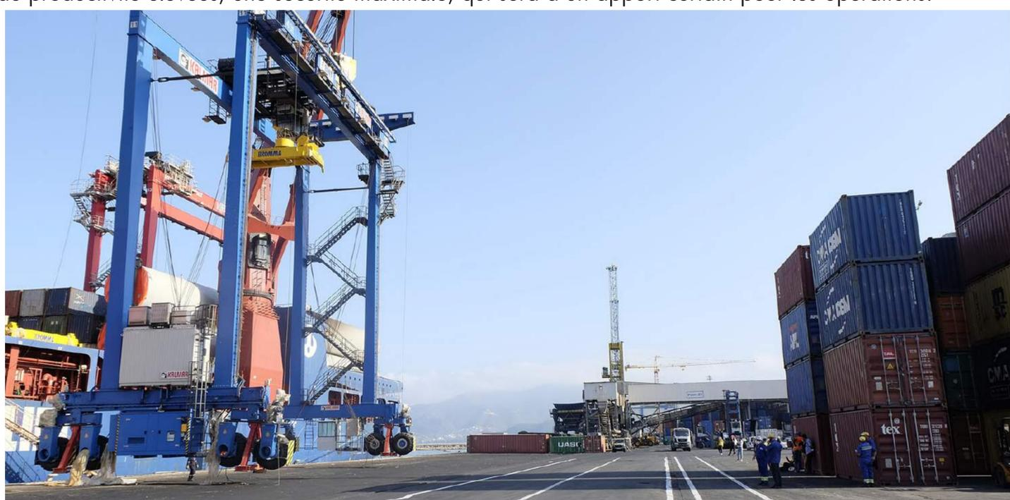
Pour rappel, le RTG Kalmar acquis par BMT, combine le meilleur de la technologie Diesel et électrique, pour des économies de carburant, de faibles émissions et un entretien facile. À 1 000 heures, il a l'un des intervalles de maintenance les plus longs du marché.
