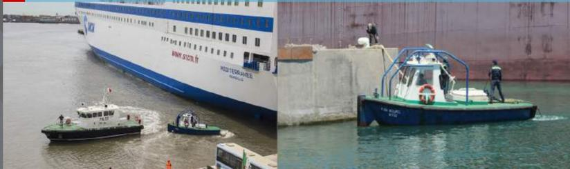
A l'arrivée du navire, le lamanage consiste à veiller à l'amarrage du navire et à la constance des bonnes conditions de son arrimage à quai, tout au long de l'escale.
